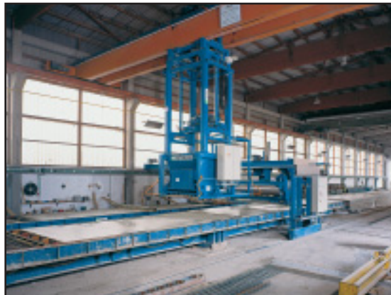
Бетонораздатчик на кране
