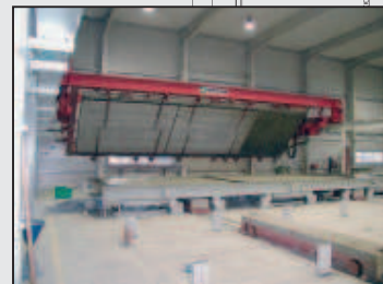
Передвижной поворачивающий автомат мостовой конструкции
