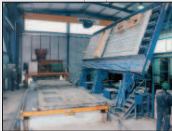
Стационарный поворачивающий автомат с системой вакуумного всасывания
