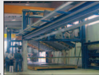
Стационарный поворачивающий автомат с вакуумным оборудованием и отцепляемой поворачивающей траверсой
