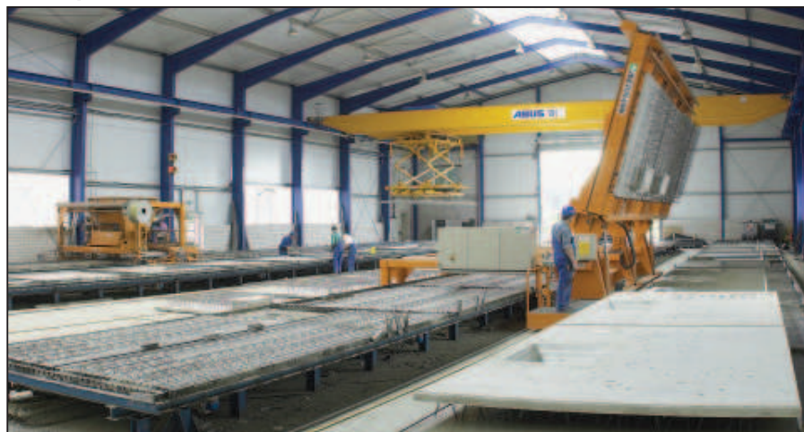
Передвижной поворачивающий автомат с системой вакуумного всасывания
