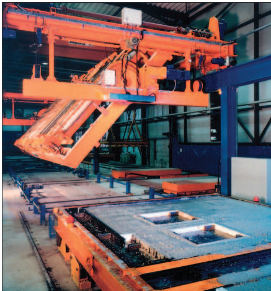
Обслуживаемый краном поворачивающий автомат с оборотным поддоном
