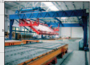
Передвижной поворачивающий автомат порталного типа
